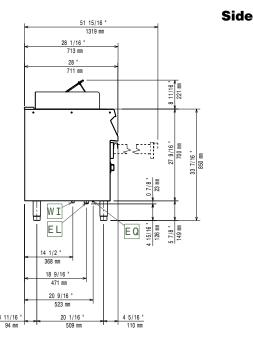
**EI** = Electrical inlet (power) **EQ** = Equipotential screw
